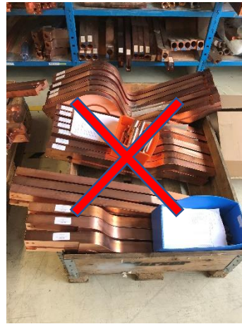
Ladungsträger falsch eingesetzt, kein Schutznetz verwendet, Verletzungsgefahr
